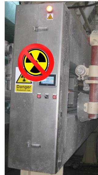
Los scanners cerrados **smartSCAN** "O Frame", disponen de un sistema de Limpieza en la Zona de Garaje, específico para máquinas con mucho polvo. Presurización del Scanner a través de un Ventilador Centrifugo, evitando que el polvo y la Suciedad entren dentro del scanner manteniendo la mecánica interna en perfecto estado.
