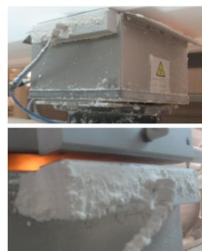
Limpieza continua de las Ventanas de Medida de los Sensores, a través de Boquillas o Labios sopladores, consiguiendo que el Polvo no afecte a la medida, garantizando la misma, para realizar un óptimo control MD tanto de Gramaje como de Humedad, así como una óptima medida del perfil CD.
